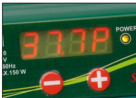
Display con temperatura in fase di programmazione (temperatura seguita da "P")
