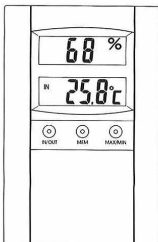
Avec cet Hygro-Thermomètre intérieur/extérieur, vous venez d'acquérir un équipement électronique de précision permettant de mesurer la température intérieure et extérieure ainsi que l'humidité de l'air.
