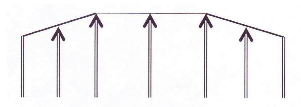
5) Montage du perchoir Enfoncer les poteaux de 0.50 m et clouer le perchoir de 2.00 m.
