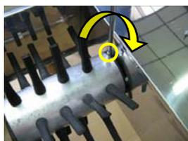
6. Serrer les 3 boulons avec la clé Ø 8 mm pour fixer le rouleau pour cailles à son support ;
