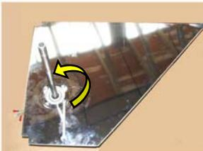
4. Dévisser les 4 boulons placés sur le panneau de division avec la clé hexagonale n.10 ;
