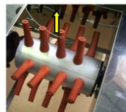
7. Tirer le câble jusqu'à l'insertion complète du doigt en caoutchouc ;
