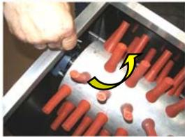
6. Dévisser la vis à l'extrémité du rouleau avec la clé d'Allen ;
